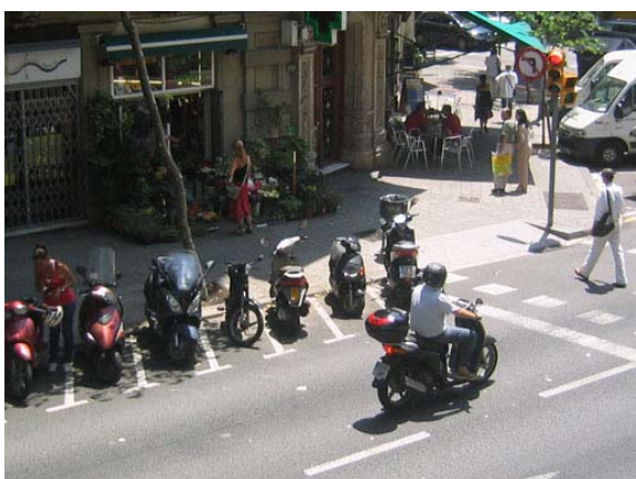
Imatge 8. Exemple aliè a Castellar. L'estacionament de motocicletes evita l'aparcament de cotxes i allibera la visual entre conductor i vianant en el pas.
