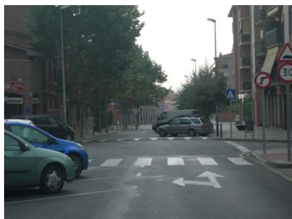
Imatge 13. Carrer Barcelona, entre Àngel Guimerà i Arbreda. Alternança de costat d'estacionament com a reductor de velocitat. Permet una bona visibilitat a l'hora de sortir.
