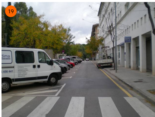
19 C. Jaume I. Exemple d'estacionament en semi-bateria inversa. Aquesta configuració és recomanable, ja que millora la visibilitat en la maniobra de sortida de l'aparcament. Tot i així s'observa un vehicle estacionat en vorera.
