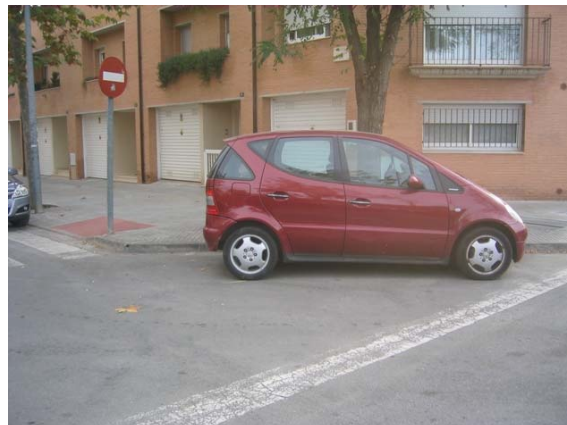
Imatge 7. Carrer Josep Tarradellas amb Josep Irla. Els xamfrans allarguen innecessàriament l'itinerari de vianants i els vehicles que hi aparquen poden suposar un obstacle per a conductors que s'incorporen a una via.
