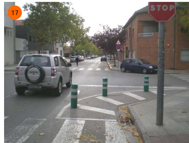
En una de les cantonades s'ha eliminat el xamfrà mentre que a l'oposada no, i s'observa com hi ha un vehicle estacionat a dins de la intersecció.
