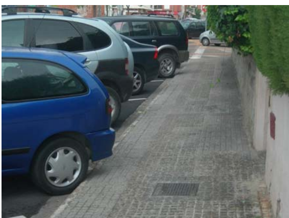
Imatge 12. Detall estacionament en semibateria inversa i ocupació mínima de la vorera.
