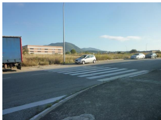
Imatge 12. C. d'Osona. Els carrils tenen una amplada excessiva, de 4 metres, fet que implica passos de vianants molt llargs.
