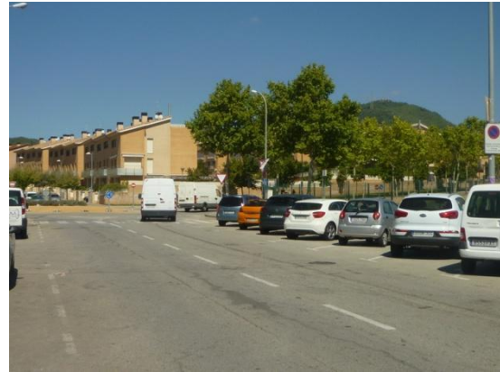
Imatge 32. Aparcament en semibateria tradicional al lateral del carrer de la Garrotxa
