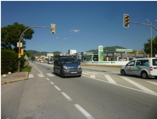
Imatge 37. Exemple d'estrenyiment de la calçada, amb mitjana de pintura a la carretera de Sabadell
